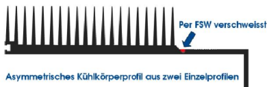
Asymmetrisches Kühlkörperprofil aus zwei Einzelprofilen
