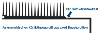
Soudage FSW d'un refroidisseur constitué de profilés (avec une vue détaillée du cordon de soudure)
